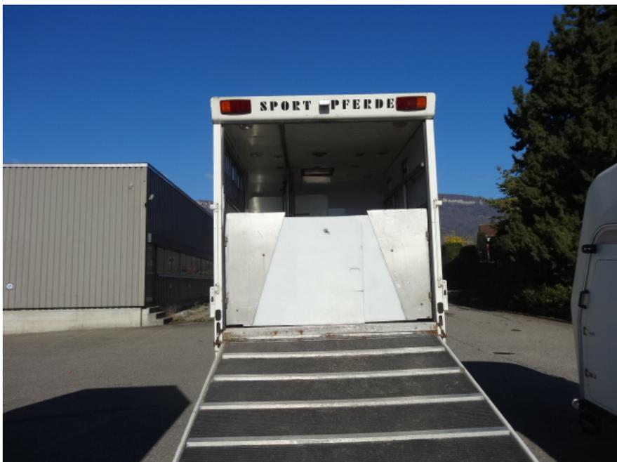
ABSENKBARE HINTERACHSE, RAMPE MIT GUMMITRETSCHICHT UND
